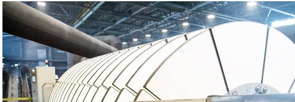
Новое оборудование позволяет снизить себестоимость переработки полезных ископаемых. Работу фильтров обеспечивает автономная установка с собственным насосом, которая обеспечивает экономию энергии 640 кВт ежечасно, если сравнивать с демонтированными тканевыми фильтрами ДОО-100. На КДФ-90 для просушки можно подавать более густую массу, что позволяет сократить расходы технической воды. Керамические расходники требуют замены раз в полтора года, в то время как замену ткани производили каждый месяц.
