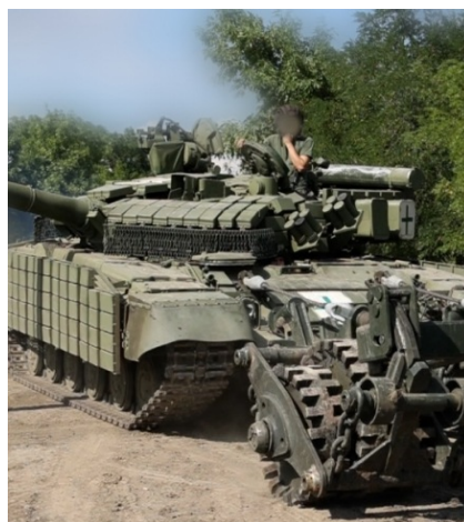
Протимінні трали допомагають танкам безпечно долати заміновані ділянки.
