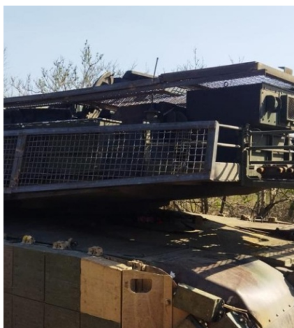
Сталеві антидронові екрани для різних видів техніки підвищують її живучість в умовах інтенсивних бойових дій
