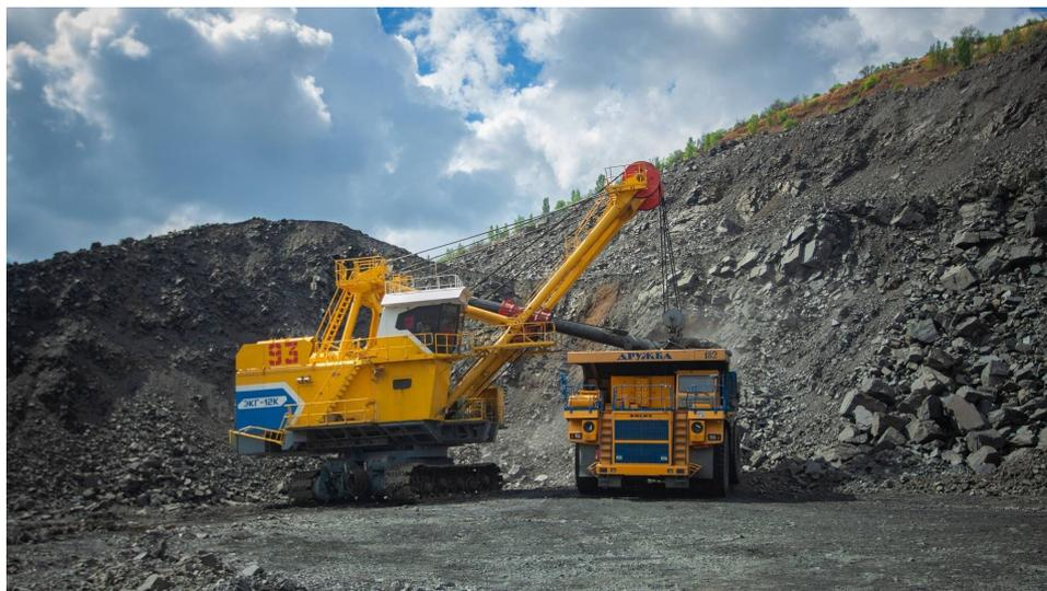
В этом году комбинат планирует начать горячие испытания технологической линии второй очереди комплекса циклично-поточной технологии в Первомайском карьере. Этот проект позволит уменьшить расстояние откатки большегрузных автомобилей, снизит себестоимость продукции и улучшит эффективность горных работ.
