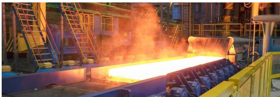
Масштабная реконструкция ЛПЦ-1700 стартовала в 2017 году и проходила в несколько этапов. На первом – в эксплуатацию введена нагревательная печь №1 и установлена большегрузная пневматическая моталка. На втором – установлены промежуточное перематывающее устройство «coilbox», гидросбивы, реверсивная черновая клеть и другое технологическое оборудование. Также выполнено усиление и модернизация блока чистовых клетей прокатного стана.
