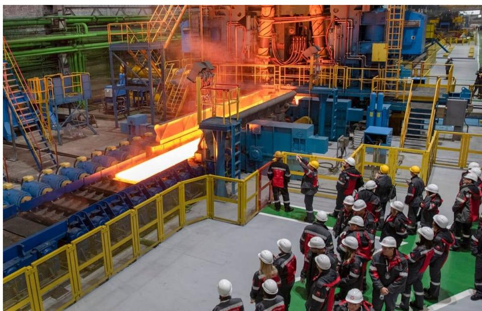
Новая реверсивная клеть с оборудованием для вертикального обжатия сляба оснащена автоматизированной системой управления, позволяющей стабильно получать качественный подкат для чистовой группы клетей. Установленный после черного блока стана «coilbox» выполняет промежуточную смотку длинных раскатов при прокатке тяжелых рулонов.
