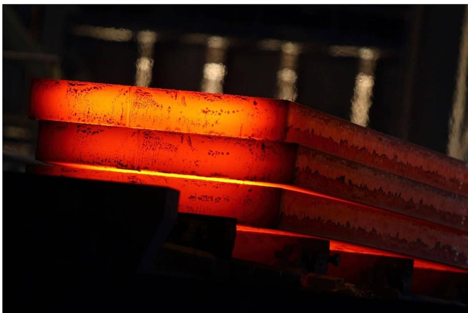
Из этих полуфабрикатов производят горячекатаный прокат на модернизированном стане «1700». Кроме того, новые слябы пользуются спросом у перекатчиков благодаря улучшенному химическому составу и отличным геометрическим характеристикам. Стальной прокат, изготовленный из таких полуфабрикатов, подходит для всех сфер применения, а особенно востребован в
