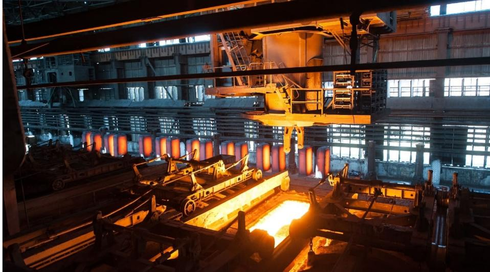
Основной вид оборудования, используемый при производстве горячекатаного проката – это прокатные клети, из которых состоит прокатный стан. Например, станы для производства рулонов могут включать до 15 клеток типа «кварто» (то есть в каждой из них две пары прокатных валков) и клети с вертикальными валками, которые формируют боковые кромки листа.
