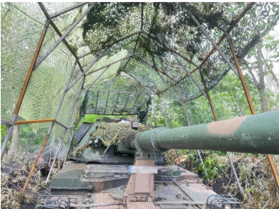
Сооружения универсальны: их можно использовать для маскировки и защиты большинства моделей техники на боевых позициях — самоходных артиллерийских установок, танков, автомобилей для перевозки людей. Первые образцы «ловцов ланцетов» на фронте показали себя как надежная защита, которая останавливает вражеские дроны и бережет технику.
