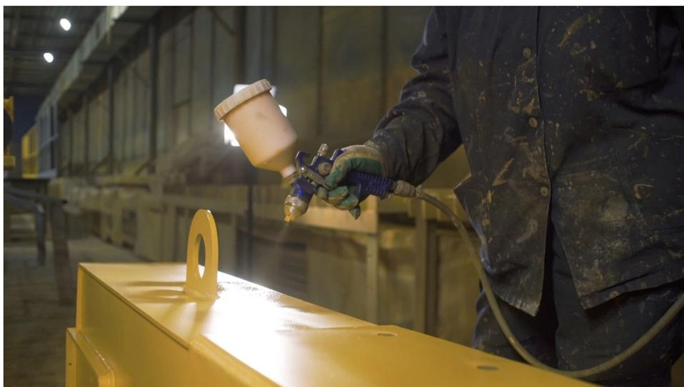
Лишь правильно подготовленные изделия и конструкции следует красить. Ведь в случае со сталью краска – это не только элемент декора, но и часть комплексной защиты от образования коррозии и преждевременного разрушения.
