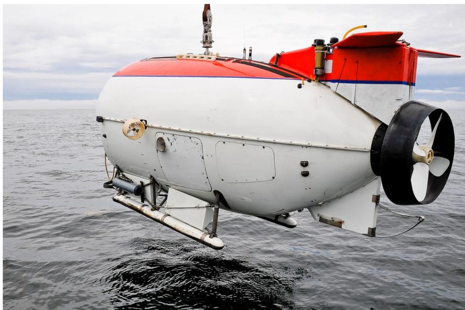
Также примечательно, что Нарсис Монтуриоль-и-Эстарриоль в конструкции своих субмарин придерживался идеи двухкорпусной конструкции. Это значит, что внутри обтекаемого, относительно легкого и водонепроницаемого наружного корпуса находится водонепроницаемый прочный корпус, способный выдерживать повышенное давление. Но если у испанского конструктора наружный корпус был деревянным, то сейчас его делают из стали и покрывают специальными резиновыми смесями для снижения шума во время передвижения.
