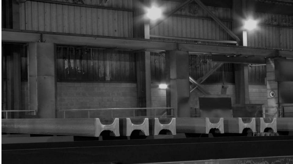
Остальные виды фасонного проката производят из блюмов и квадратов различных сечений. Из сталеплавильных цехов полуфабрикаты отправляют в прокатные цеха. Там его нагревают и начинают обжатия, чтобы придать нужную форму.
