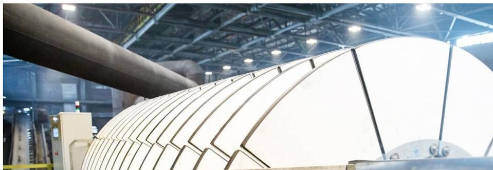
Новое оборудование позволяет снизить себестоимость переработки полезных ископаемых. Работу фильтров обеспечивает автономная установка с собственным насосом, которая обеспечивает экономию энергии 640 кВт ежедневно, если сравнивать с демонтированными тканевыми фильтрами ДОО-100. На КДФ-90 для просушки можно подавать более густую массу, что позволяет сократить расходы технической воды. Керамические расходники требуют замены раз в полтора года, в то время как замену ткани производили каждый месяц.
