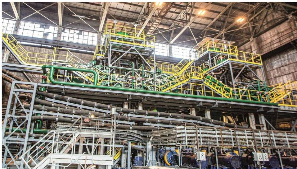
Технологическую линию модернизировали с весны 2019 года. За этот период был построен участок тонкого грохочения и обезвоживания, а также обновлена одна из секций обогатительной фабрики комбината.
